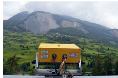
Il georadar sul versante opposto della frana di Brienz fornisce dati importanti per valutare la situazione.
