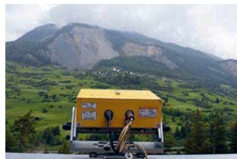
Il georadar vi da la costa visavi a la bova da Brinzauls furnescha datas impurtantas per valitar la situaziun.
