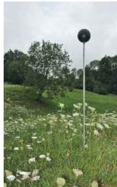
Schwarz lackierte, hohle Kupferkugeln mit integriertem Thermometer (Black Bulb) wurden auf zwei Meter hohen Stahlstangen aufgestellt, um die «gefühlte» Temperatur zu messen.
