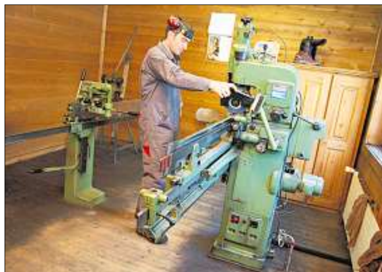
Damit die Säge rund läuft: Alois Federspiel, Zuständiger für die Schärferei, widmet sich einem Sägeblatt.
