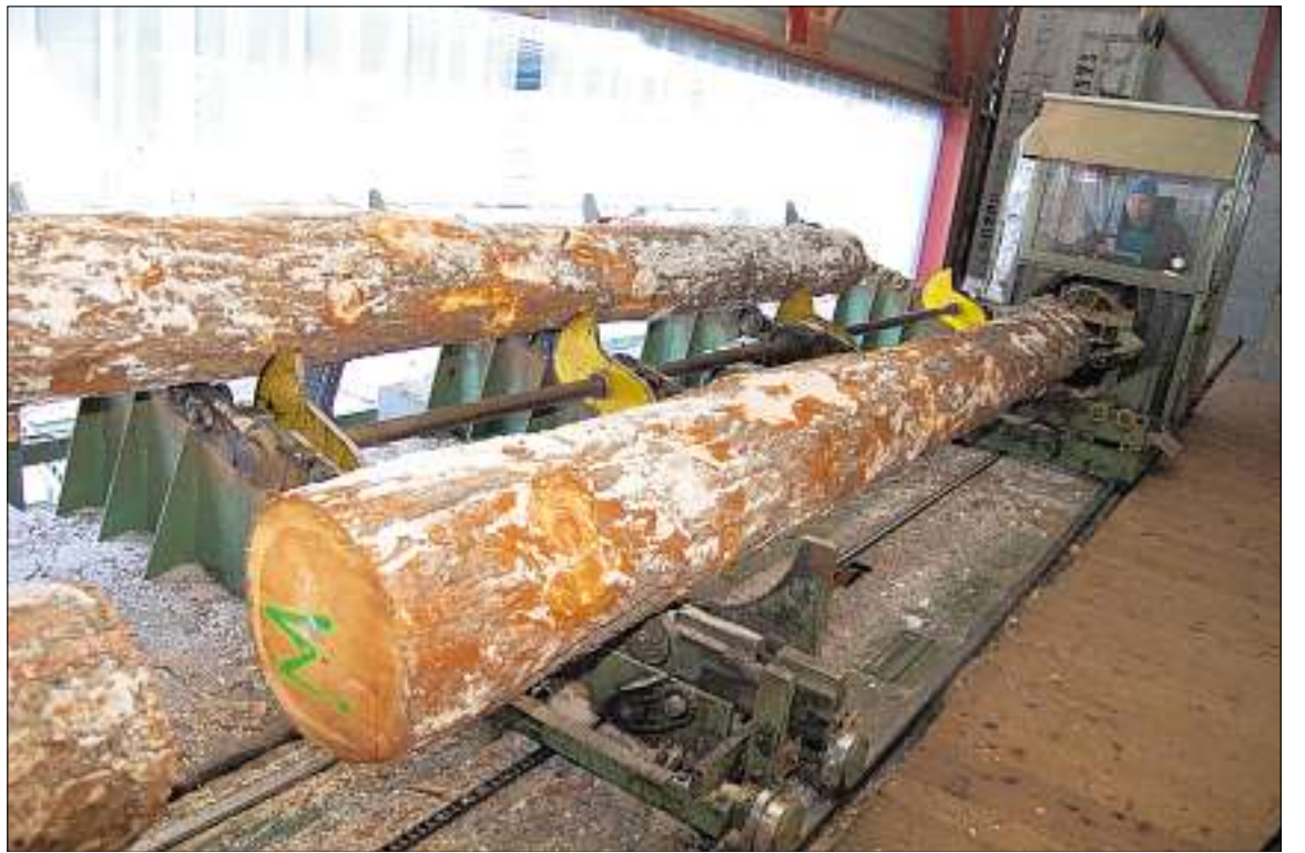
Sichtkontrolle des Rundholzes auf dem Weg zum Sägeblatt: Der Säger Herbert Waldegger sieht jeden Baumstamm aus der Nähe, bevor er diesen zu Schnittholz verarbeitet. (Fotos Silvia Kessler)
