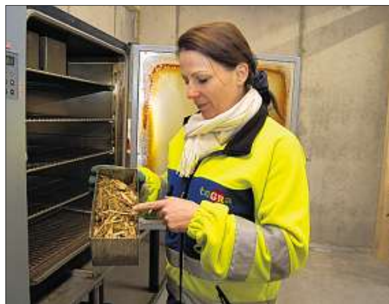
«Gepflegte Schnitzel»: Anita Senti von der Axpo Tegra AG erklärt, wie der Feuchtigkeitsgehalt der Holzschnitzel gemessen wird. (ke)
