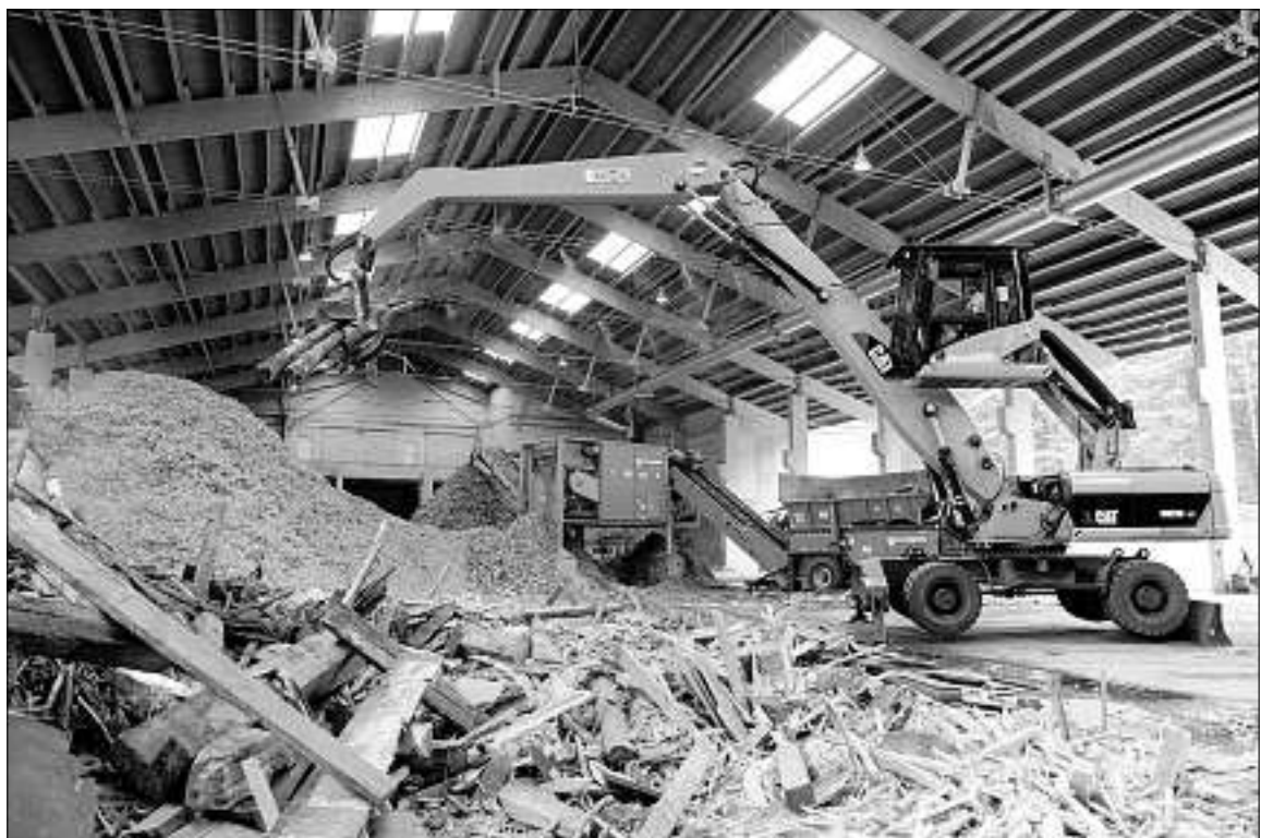
Aus Restholz wird Energie: In der Axpo Tegra AG in Domat/Ems werden Waldrestholz, Rinde, Hobelspäne und unbehandeltes Altholz zu Brennschnitzeln verarbeitet. (Foto Nadja Simmen)
