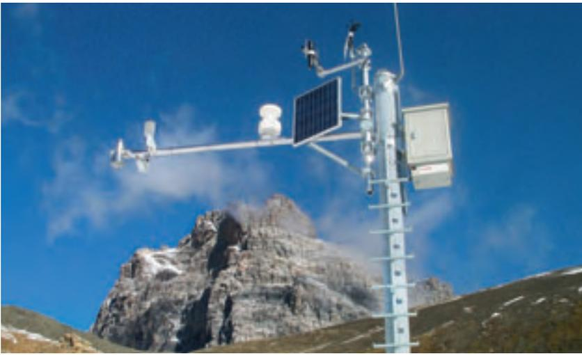
**Abb 12** Im Herbst 2008 wurde am Fuss des Piz Ela oberhalb Bergüns, auf 2725 m ü. M., eine neue IMIS-Station in Betrieb genommen. Solche automatischen Messstationen werden im gesamten schweizerischen Alpenraum eingesetzt. Foto: Daniel Lussi
