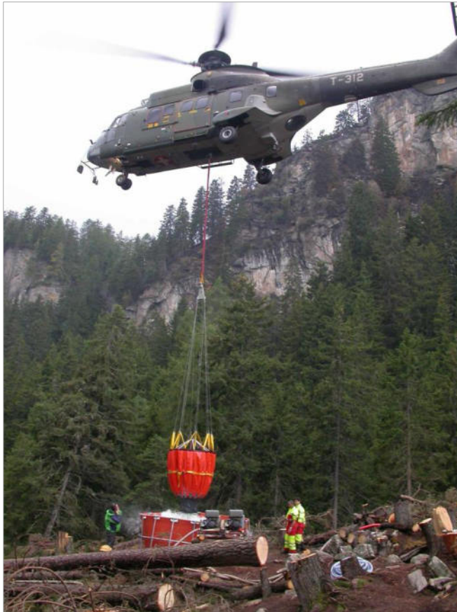
Abbildung 8: Einsatz des Superpuma Gross-Helikopters der Schweizerischen Armee an mobiler Wasserentnahmestelle.
