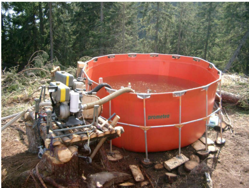
Abbildung 7: Mobile Wasserentnahmestelle mit Motorspritzpumpe für den Einsatz der Bodentruppen oder Wasserentnahme durch Helikopter.
