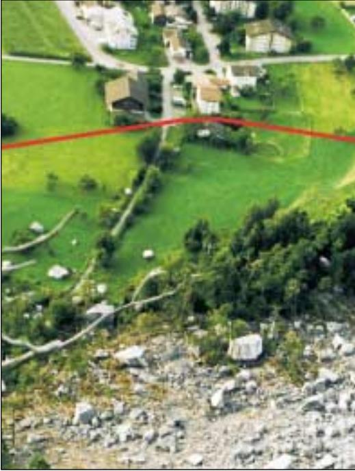
Abb. 8: Ablagerungsbereich mit Einzelblöcken. Die rote Linie bezeichnet die Rote Gefahrenzone.
