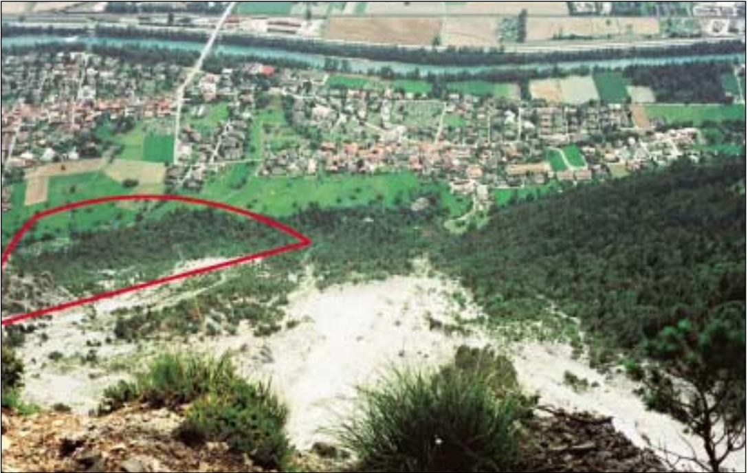
Abb. 3: Vor dem Ereignis. Periodische, kleine Abbrüche haben den Schutzwald auf einen schmalen Streifen zurückgedrängt. (Aufnahme Juli 2000. Rote Linie: Grenze Sturz und Ablagerungsraum: Sturz 6. 7. 2001.)
