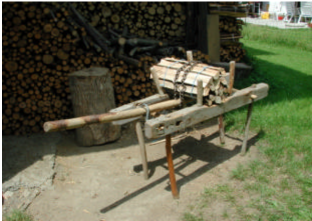
Abb. 3: Der Faschinenbock. Auf ihm werden die Faschinen erzeugt.
