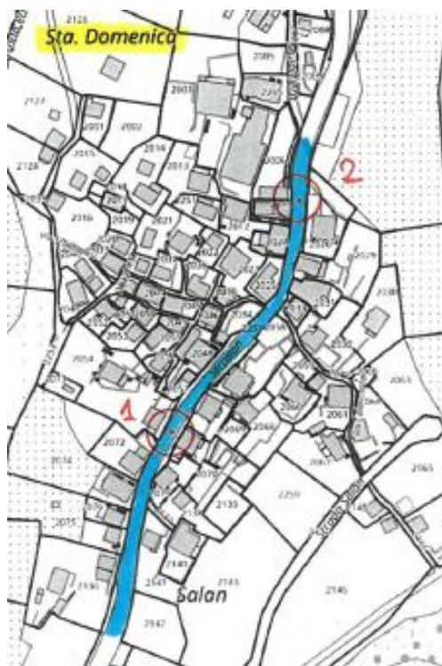
Figura 7 "Situazione con posizione carotaggi PAK"
