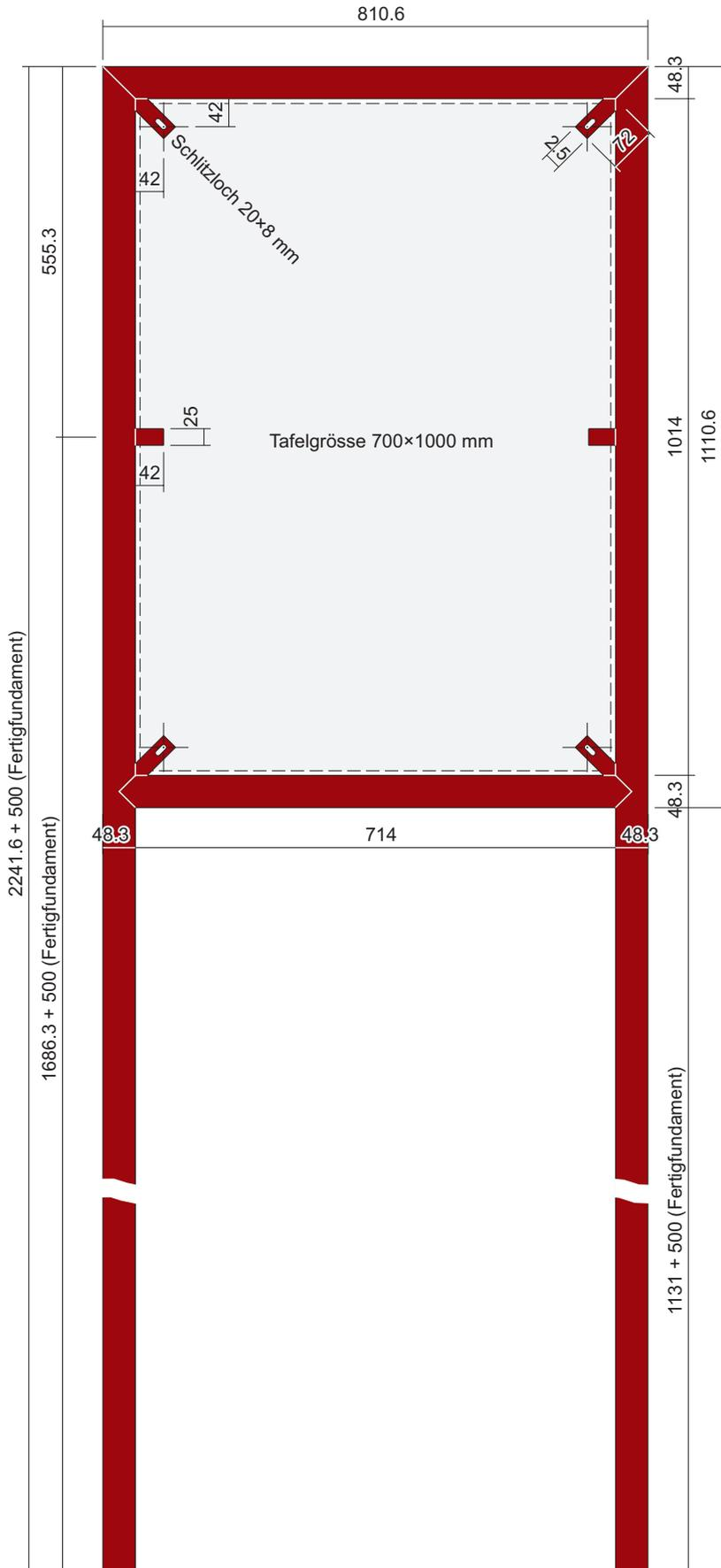
**Herstellung:** Gasrohr 1.5" 48.3x3.25 mm; Toleranz  $\pm 1.0$  mm; Feuerverzinken – Staubstrahlen – Grundieren – Spritzen
