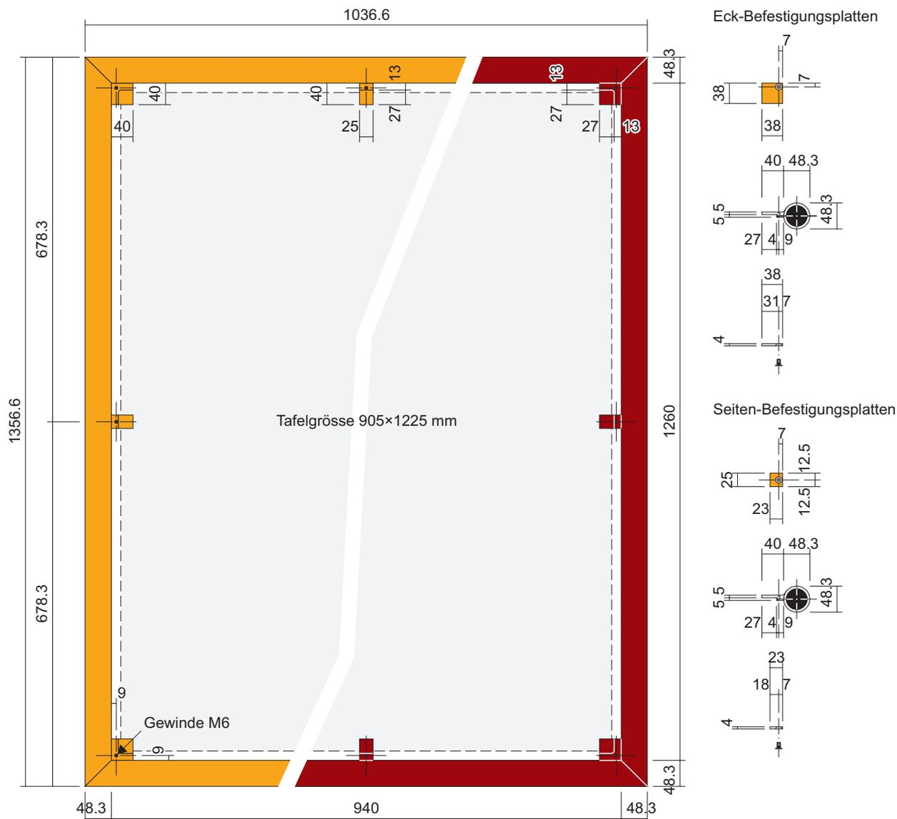
**Herstellung:** Gasrohr 1.5" 48.3×3.25 mm; Toleranz ±1.0 mm; Feuerverzinken – Staubstrahlen – Grundieren – Spritzen
