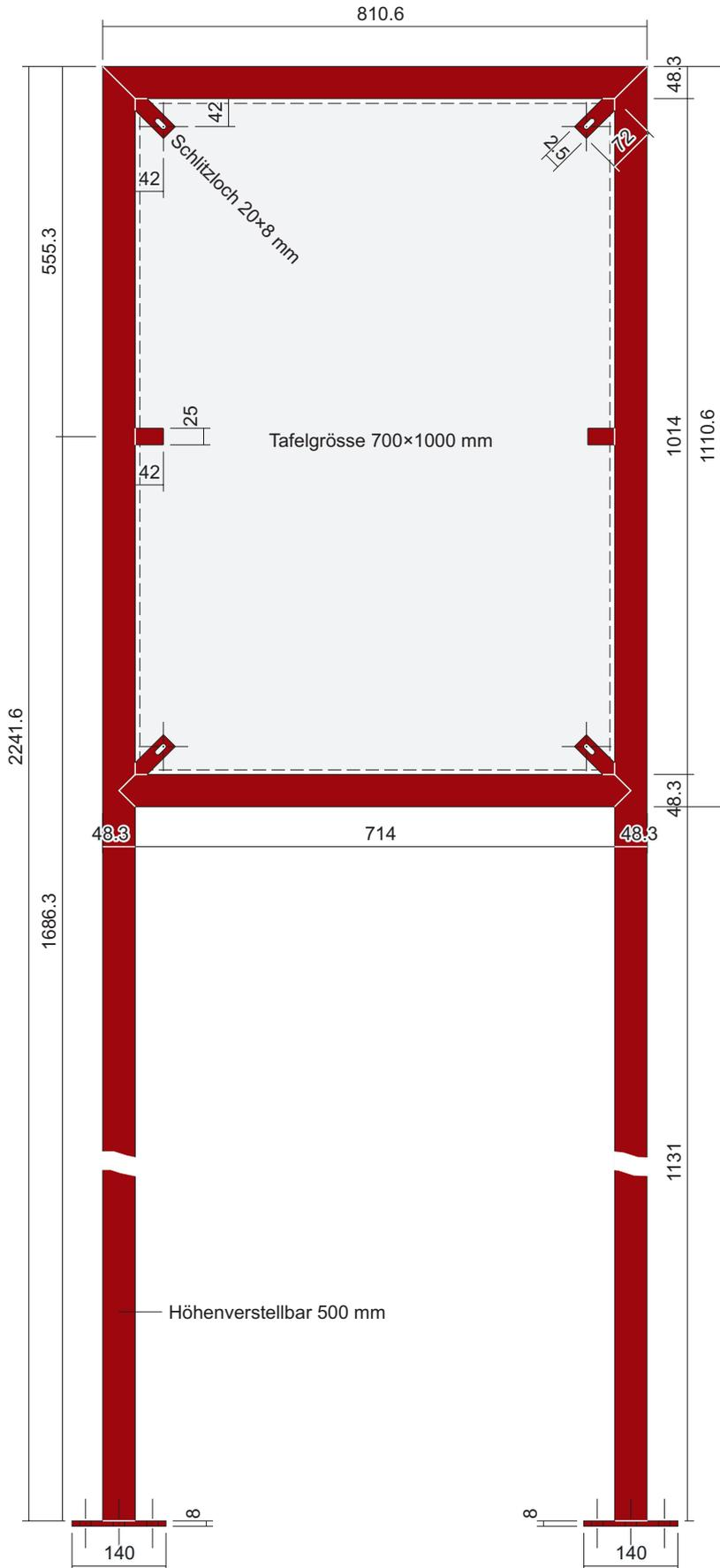
**Herstellung:** Gasrohr 1.5" 48.3×3.25 mm; Toleranz ±1.0 mm; Feuerverzinken – Staubstrahlen – Grundieren – Spritzen
