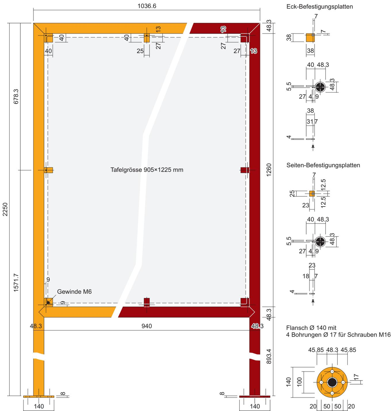
**Herstellung:** Gasrohr 1.5" 48.3×3.25 mm; Toleranz ±1.0 mm; Feuerverzinken – Staubstrahlen – Grundieren – Spritzen
