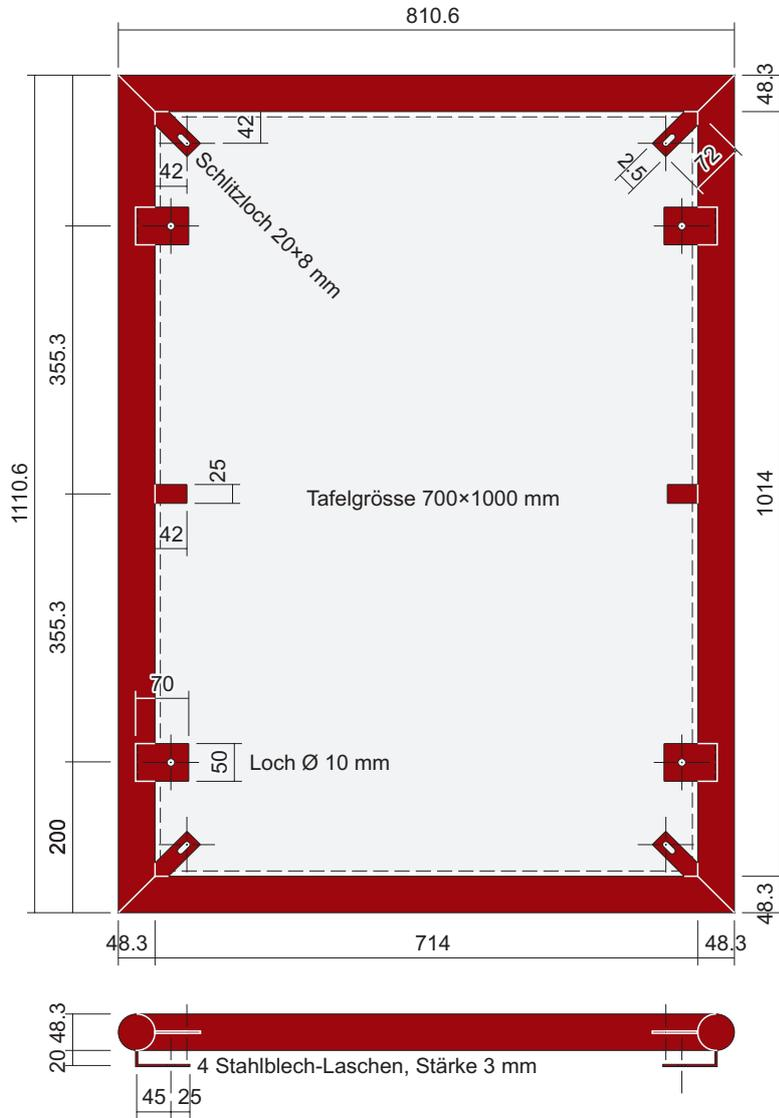
**Herstellung:** Gasrohr 1.5" 48.3×3.25 mm; Toleranz ±1.0 mm; Feuerverzinken – Staubstrahlen – Grundieren – Spritzen
