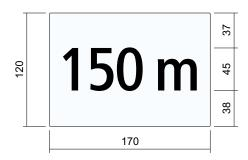
**Herstellung:** Alureliefguss Cuprasil 75; t = 5 bzw. 8 mm; Ecken runden/brechen: R = 1 mm
