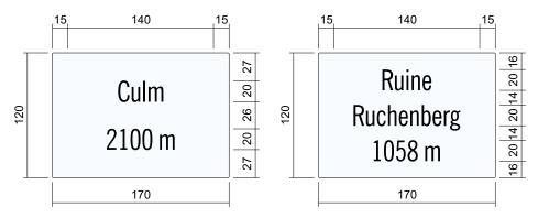
**Herstellung:** Alureliefguss Cuprasil 75; t = 5 bzw. 8 mm; Ecken runden/brechen: R = 1 mm
