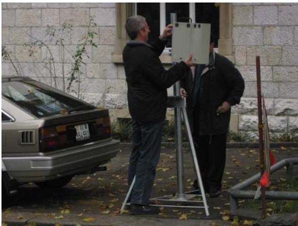
Abb. 18: Aufbau eines mobilen Radarmessgerätes Quelle: Eigene Erhebungen
