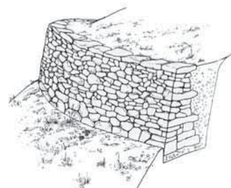
Muro di sostegno a secco con copertina in pietre posate di piatto (Fondazione Azioni per l'ambiente 1996, 72).
