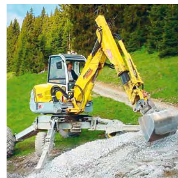
Fig. 8 Scavatrice a ragno
