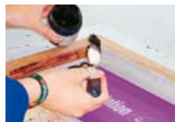
Fig. 20 Stampa serigrafica: il motivo viene posto sul tessuto di stampa ed esposto a una forte luce. Nei punti in cui lo strato è coperto da una lettera, non viene indurito dalla luce e pertanto lavato via durante lo sviluppo.
