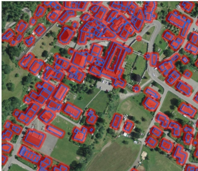
Abbildung 8-4: Gebäude mit 5-Meter-Anstandsflächen
