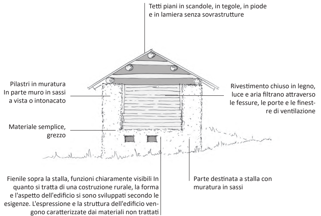
Ill. 32: particolarità costruttive delle stalle con fienile con pilastri angolari.
