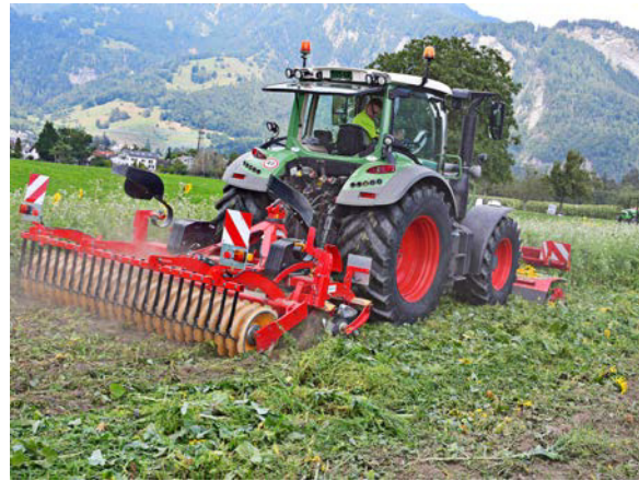
Das eigentliche Einarbeiten geschieht hier mit einer Scheibenegge, ausgerüstet mit CrossCutter Disc. (Fotos: R. Hunger)
