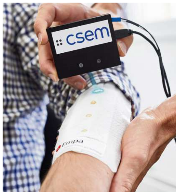
Mit dem intelligenten Pflaster lässt sich der Heilungsprozess einer Wunde überwachen. (Quelle: Antal Thoma / CSEM)
