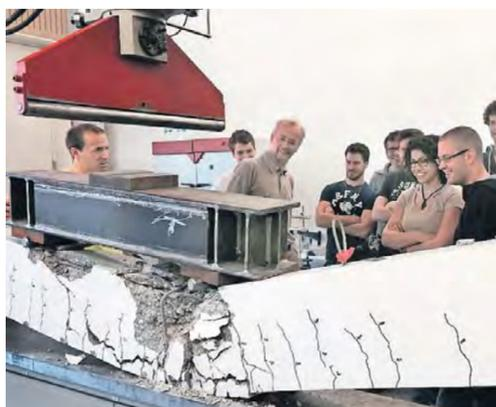
Biegeversuche am Beton-Balken im Baulabor der HTW Chur.
