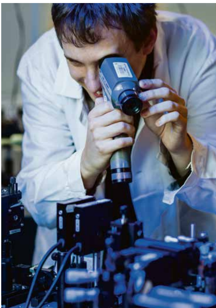
Optischer Versuchsaufbau. Mit Hilfe eines IR-Viewers können auch unsichtbare Strahlen sichtbar gemacht werden.
