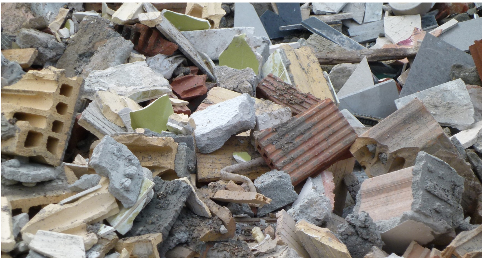
Misto minerale di demolizione
