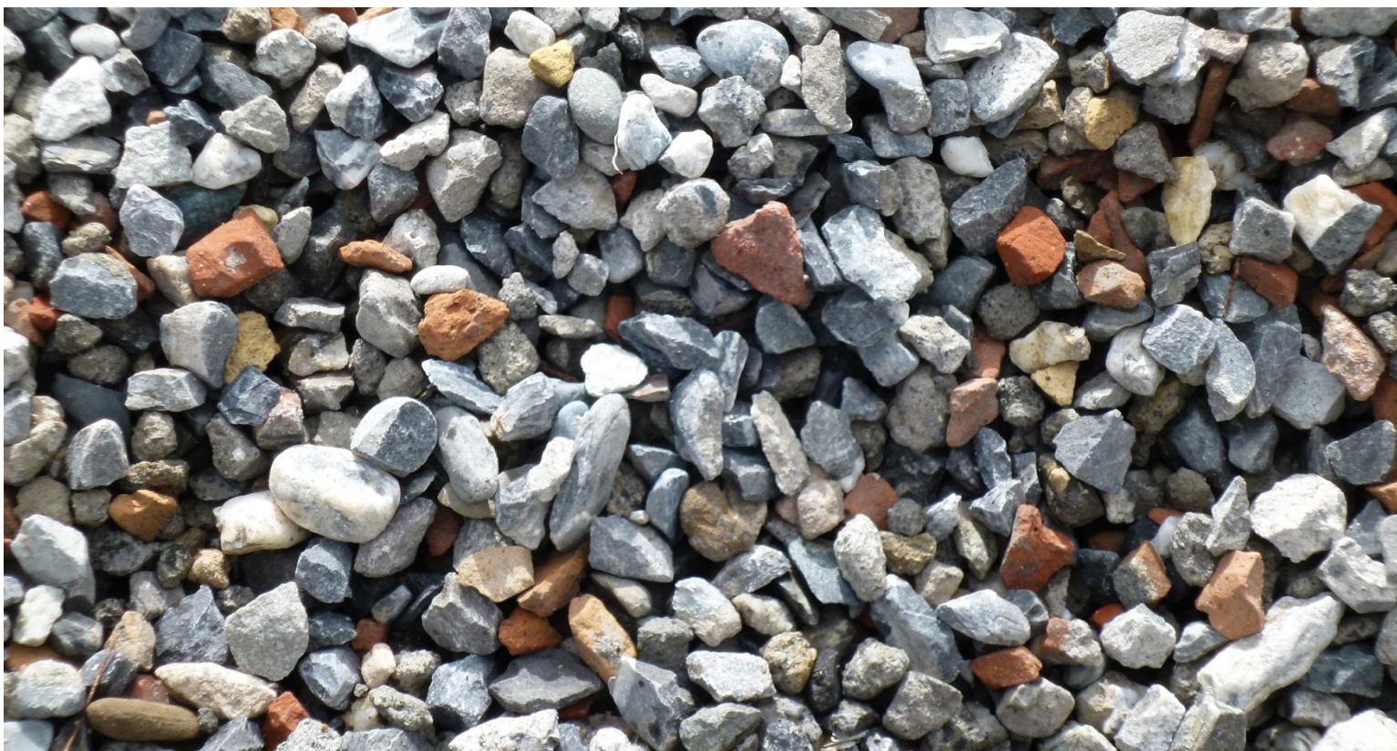
Granulato misto di demolizione
