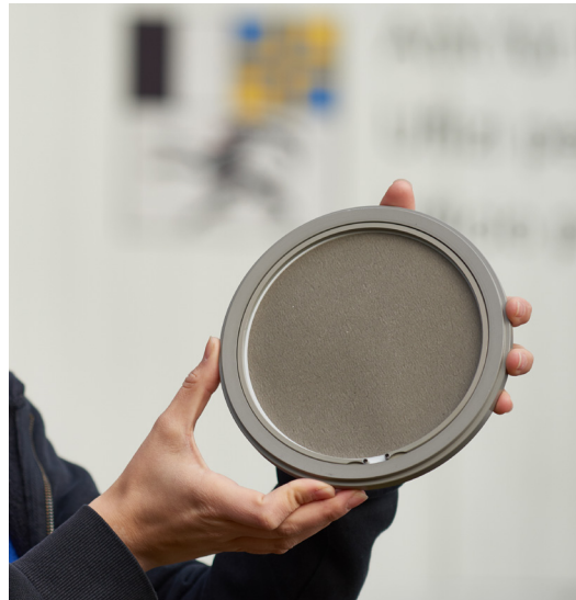
Das ANU misst an repräsentativen Standorten die Luftbelastung im Kanton Graubünden. Foto: Feinstaub (PM10)-Filter nach der Beprobung.
