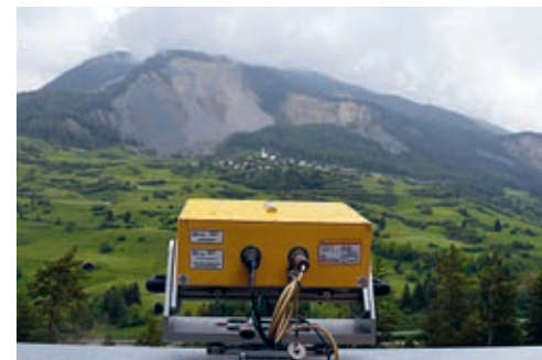
Der Georadar am gegenüberliegenden Hang der Rutschung in Brienz liefert wichtige Daten für die Einschätzung der Lage.
